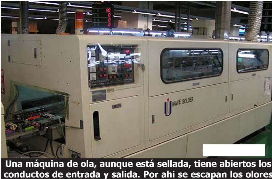
**Una máquina de ola, aunque está sellada, tiene abiertos los conductos de entrada y salida. Por ahí se escapan los olores**
